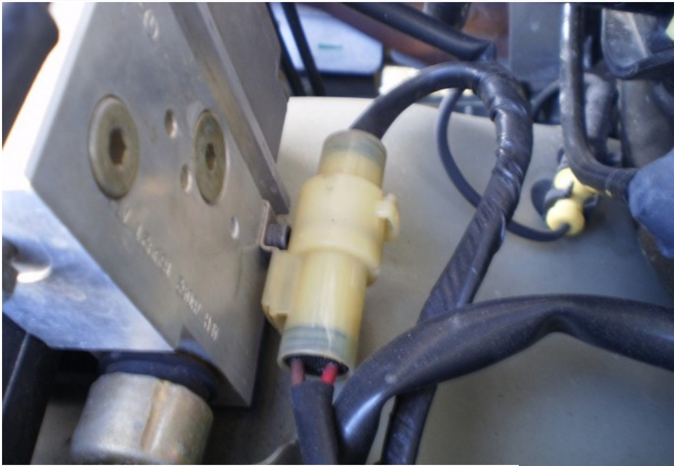
Extracción del conector negro C0501 y el conector gris C0500
