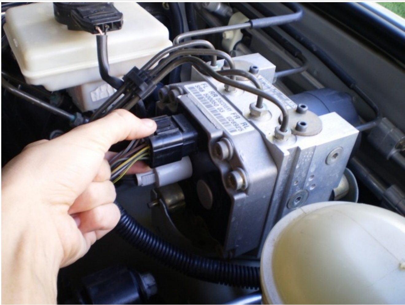
Extracción del conector negro C0501 y el conector gris C0500
